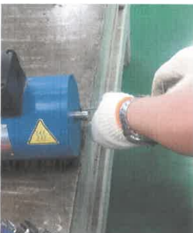
步骤 10: 将端盖装好装回去
