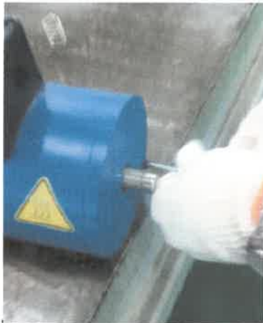
步骤 2: 用 4#内六角扳手拆下端盖上的螺丝
