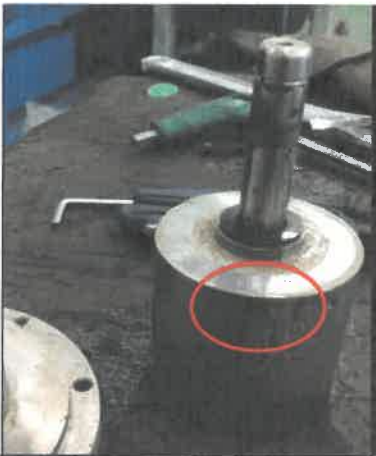
步骤 7: 检查橡胶垫, 有无老化磨损, 若有即更换
