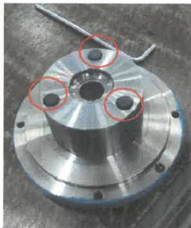
步骤 4: 取下端盖, 看三个橡胶静音柱有无磨损(静音柱与金属面平齐时即为磨损), 若有全部更换掉
