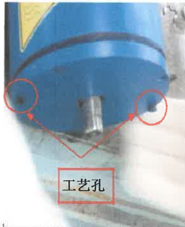
步骤 3: 若端盖紧拿不出来, 可以把拆下来的 M5 的螺丝利用工艺孔顶出来
