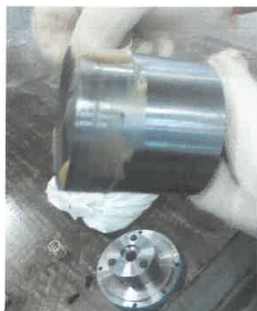
步骤 6: 润滑油均匀涂在铁芯端头衔铁部分, 锈蚀严重的整铁芯涂一层薄的润滑油
