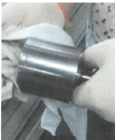
步骤 5: 用干净抹布把动铁芯擦干净, 若有锈蚀及污垢的, 用西砂纸打磨干净
